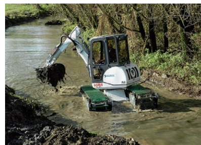
Speciální pásové minirypadlo OMB 220-40 se používá pro práci na březích vodních toků a ve vodě
