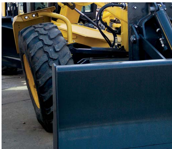
Kola grejdrů mohou být naklápěna, aby vyrovnala velké boční síly
