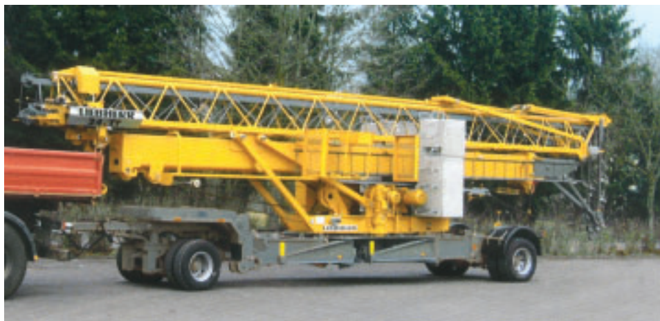
Obr. 4: Přívěsná přeprava jeřábu na stavenišťe na speciálním podvozku s podpěrami
