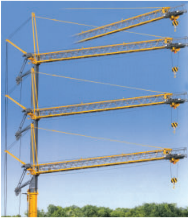
Obr. 1: Dálkově ovládaný teleskopický výsuv stožáru jeřábu s nakloněním výložníku až o 20° umožňuje zvyšovat výšku zdvihu břemene dle potřeby stavby
