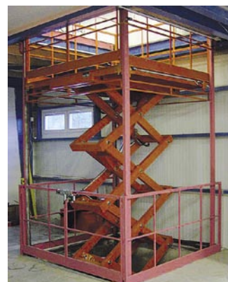
Obr. 5: Nůžková pracovní plošina spojující dvě podlaží
