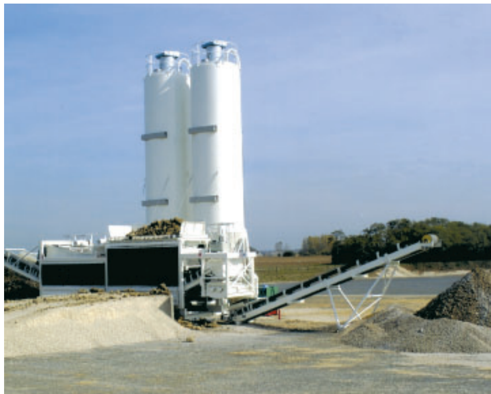
Obr. 8: Ultramobilní souprava Fayat-Ermont, model Roadpremium, na výrobu živičných obalovaných směsí
