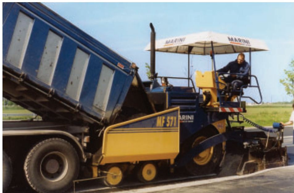
Obr. 5 – Univerzální finišer Fayat-Marini, model MF 571 HCE pro pokládku živičných nebo betonových krytů
