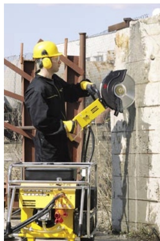
Rozbrušovací pila LS 14 o hmotnosti 9,8 kg pracující v rozmezí 2 500 – 4 000 ot./min
