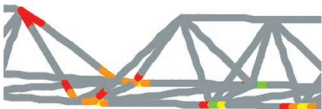
Obr. 4: obálka bezpečnosti výložníku
