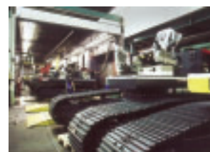
Podvozky rýpadel, připravené pro montáž horní otočné stavby
