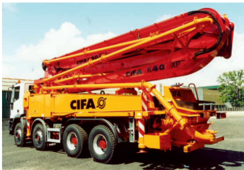
Obr. 9: Automobilní čerpadlo Cifa s výložníkem, model K 40 XRZ
