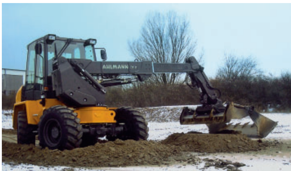
Obr. 1: Otočný nakladač Ahlmann, model AS 90tele s teleskopickým výložníkem
