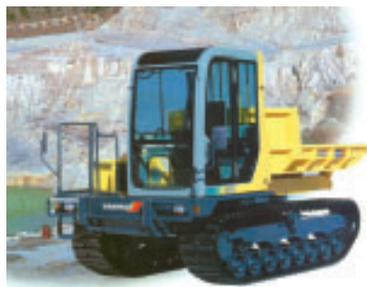
Obr. 3: Pásový dampř Ammann-Yanmar, model C 50R-3
