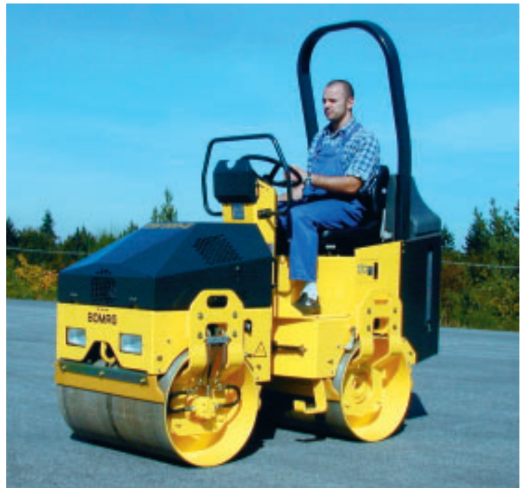
Obr. 7: Lehký tandemový vibrační válec Bomag, model BW 900-2 s kloubovým rámem
