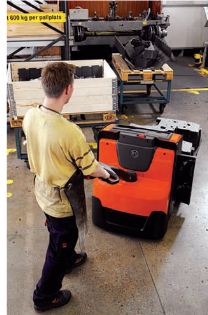
BT Levio s centrálně umístěnou řídicí ojí nabízí jednoduché ovládání (pro praváky i leváky)
