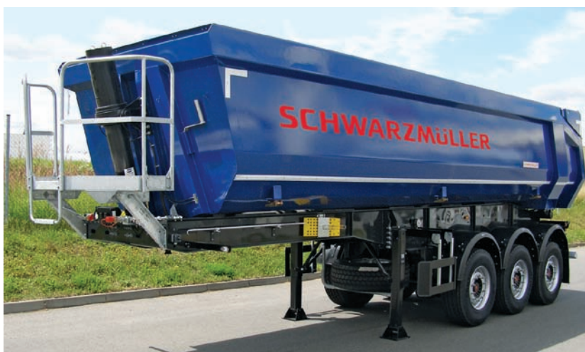
Sklápěcí návěs s půlkulatou korbou pro převoz zeminy, kamene a písku
