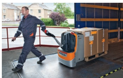
Rychlost jízdy nízkozdvíženého vozíku je závislá na úhlu vychýlení ovládací oje
